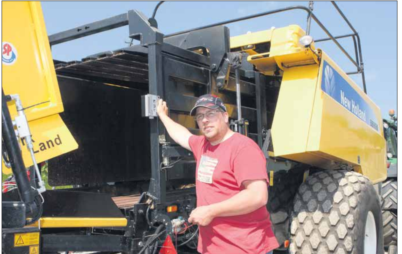
- Måleren er otte gange fjorten centimeter. Den monteres lige efter presserkanalen og måler vandprocenten i den pressede afgrøde, forklarer maskinstationsejer Anders Hansen, som fik sit første sæt leveret i går. Han har været med i udviklingen og afprøvede en prototype i høst sidste år.
